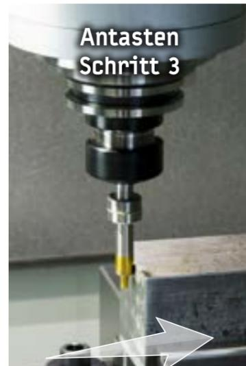
1. Das Unterteil des Kantentasters lässt sich durch leichten Fingerdruck aus der Achsmittle schieben und läuft unrund.
